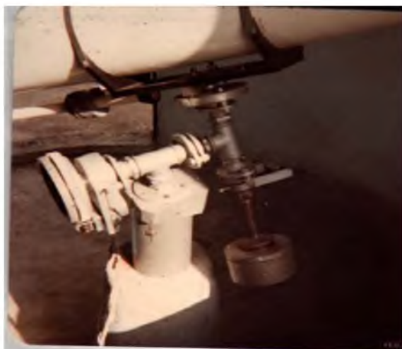
Montagem Equatorial do TENACON
