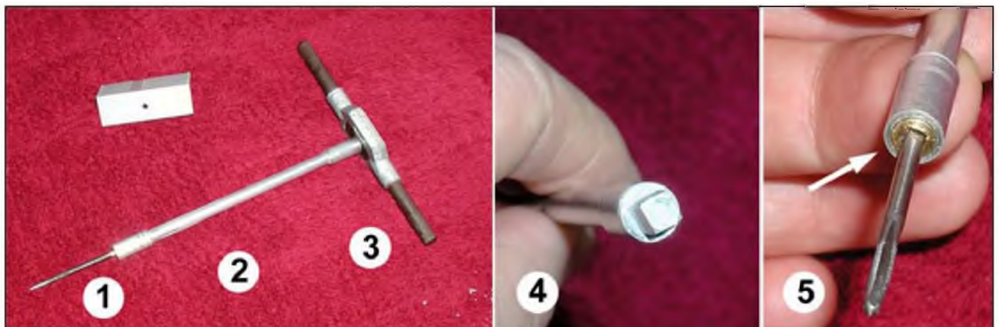
Fig.8. Diversos aspectos do extensor do macho. 1- macho M3; 2- extensor do macho; 3- desandador de machos; 4- ponta do extensor do lado do desandador; 5- ponta do extensor com macho inserido no furo quadrado (Guilherme de Almeida 2007)
