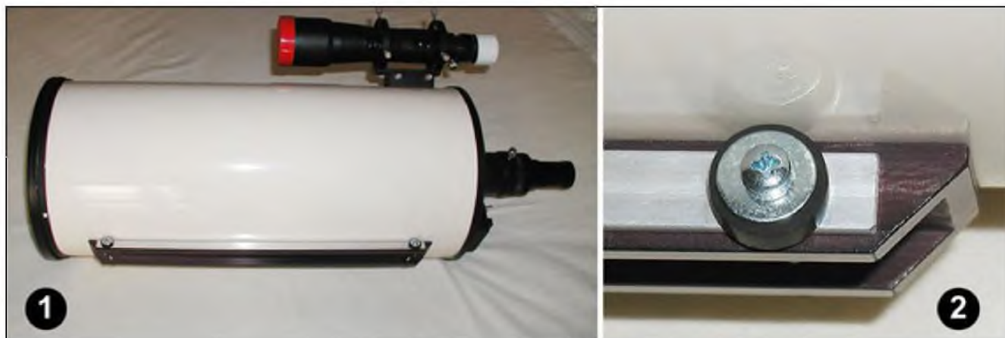
Fig.10. O trabalho acabado. 1- vista lateral esquerda, vendo-se a totalidade da régua de alumínio e os parafusos já montados; 2- pormenor da régua e de um dos parafusos, junto a uma das extremidades da dovetail (Guilherme de Almeida 2007)
