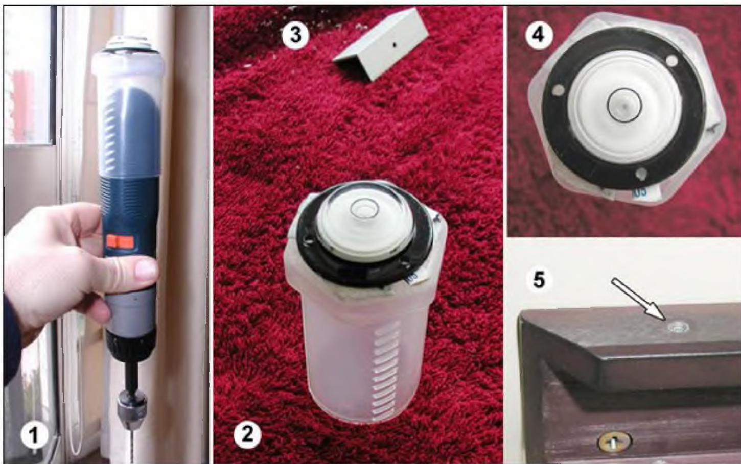
Fig. 5. Para garantir a verticalidade dos furos utilizei um nível circular de bolha de ar, adaptado ao topo de uma caixa cilíndrica (de oculares!), que encaixava justo ao cabo da aparafusadora eléctrica (1, 2 e 4). Tive de procurar muito até arranjar uma tampa com diâmetro interno bem adaptado à aparafusadora. Em 3 mostra-se a bitola de furação. Em 5 vê-se um dos furos já roscado (M3), com “perfeição profissional”. Guilherme de Almeida (2007)
