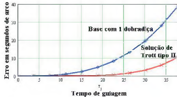
Fig. 6 Erro de guiagem em segundos de arco como função do tempo de exposição para as duas bases, simples e solução de Trott tipo II. O erro de tangente para 40 minutos é quatro vezes menor com a base de duas dobradiças do que com apenas uma.
