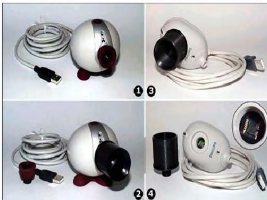
Adaptação de duas Webcams para astrofotografia. 1- Philips Vesta Pro não modificada; 2- Vesta Pro munida de um adaptador standard 1 ¼"; 3 e 4- Toucam Pro modificada. Pedro Ré (2002).
