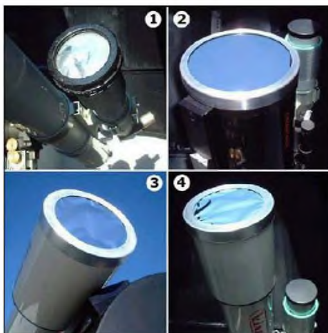
Filtros frontais para observação e fotografia do Sol: 1- Mylar (Solar skreen), telescópio Takahashi FS60; 2- Thousand Oaks, telescópio C8, 3- Baader Planetarium, telescópio Takahashi FS102, 4- Baader Planetarium, telescópio Vixen 102. Pedro Ré (2001).
