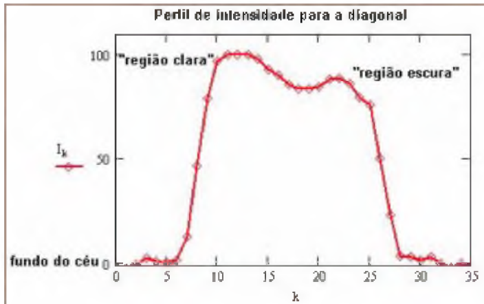
Figura 9: Gráfico da intensidade de luz como função da posição do pixel na diagonal da imagem revelando diferenças em aspectos superficiais de marte
