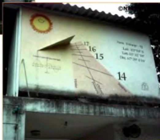
Relógio Vertical Direto Norte Cúpula no MAST (Rio,RJ) . Note ângulo com a parede igual ao complemento da latitude
