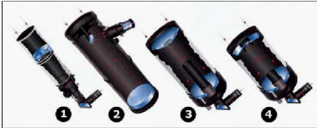
Principais tipos de Telescópios: 1 – Telescópio refrator, 2 – telescópio refletor, 3 – telescópio Maksutov – Cassegrain e 4 – telescópio Schmidt-Cassegrain
