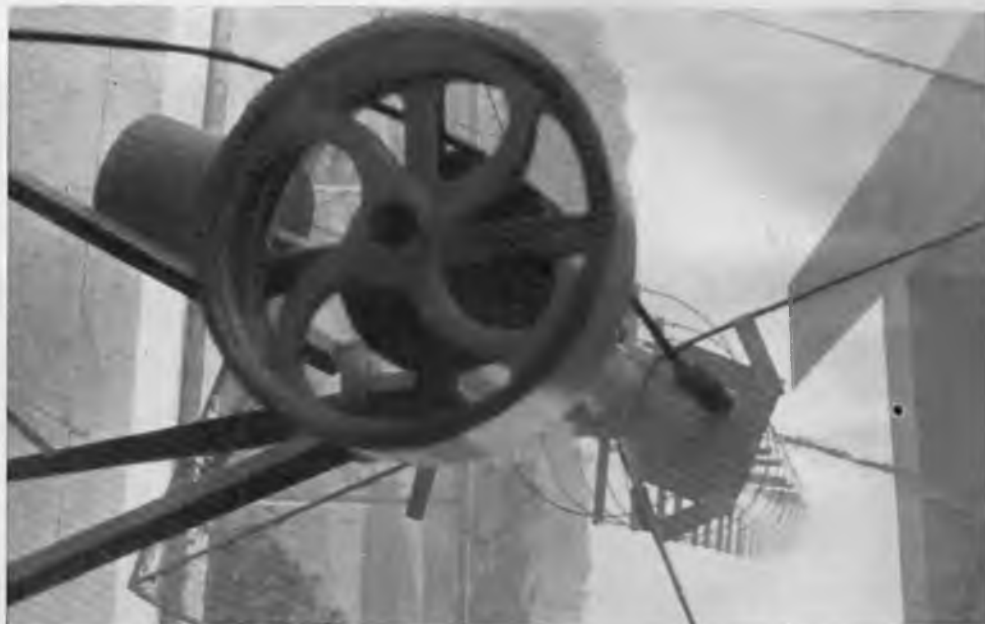
FIG. V — Vista da antena helicoidal de 13 espiras do rádio-telescópio experimental, sobre uma montagem equatorial.
